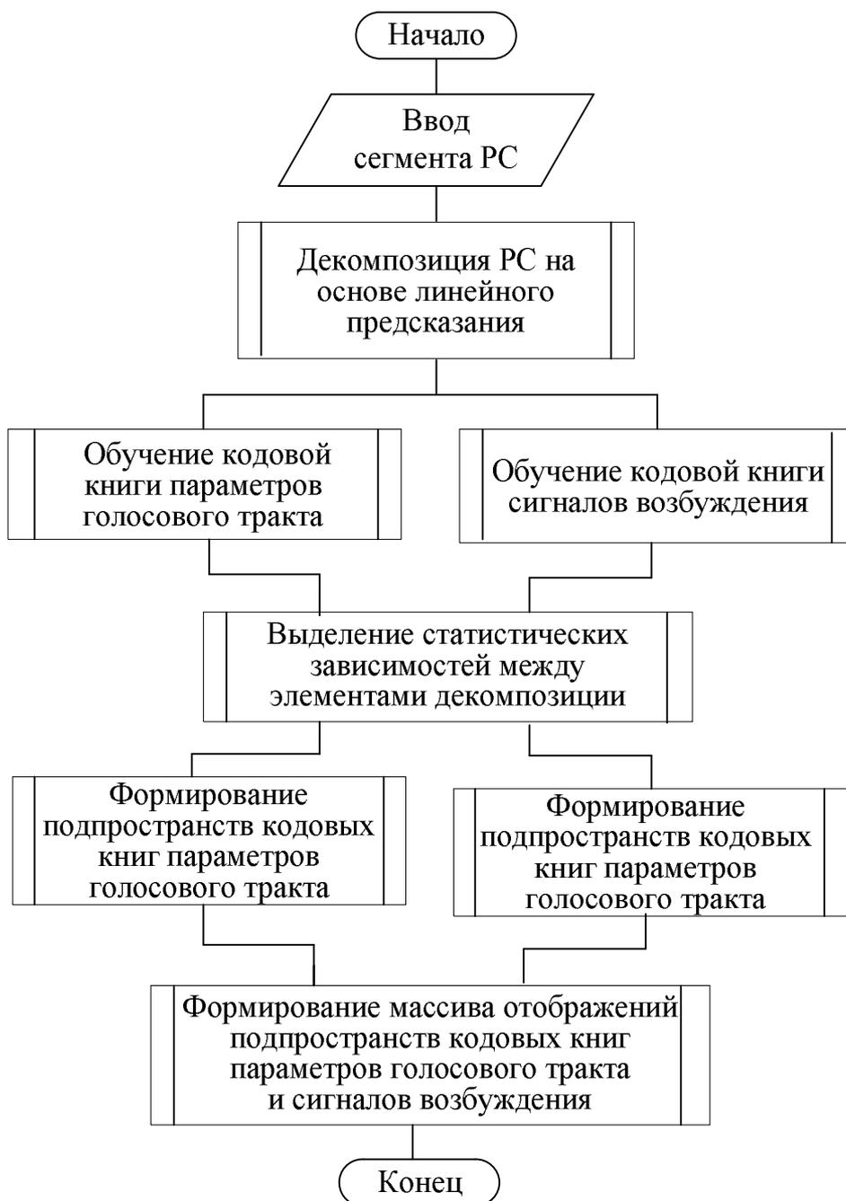
Рис.1 . Блок-схема алгоритма нахождения взаимозависимостей элементов декомпозиции речевого сигнала при линейном предсказании
