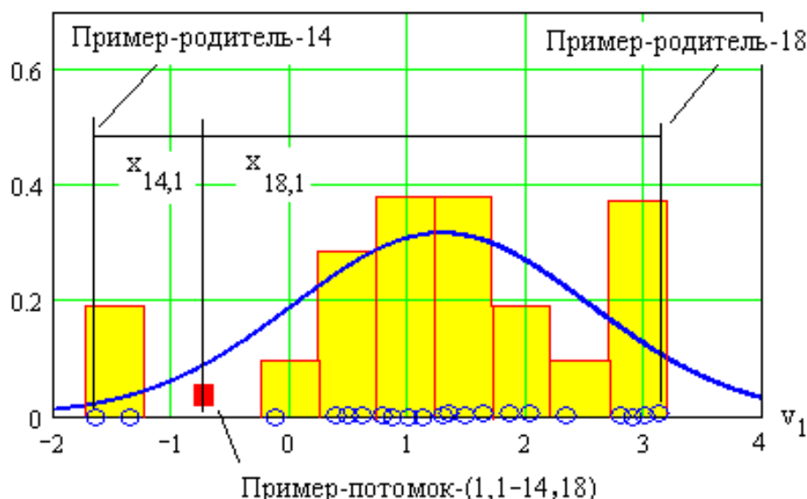
Рис. 1. Получение одного примера-потомка от наиболее далеких примера-родителя-14 и примера-родителя-18 биометрического образа «Свой»
